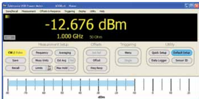
Рис. 4. Прикладное ПО датчика мощности Tektronix отображает измерение «истинного среднего» значения мощности немодулированного сигнала.
